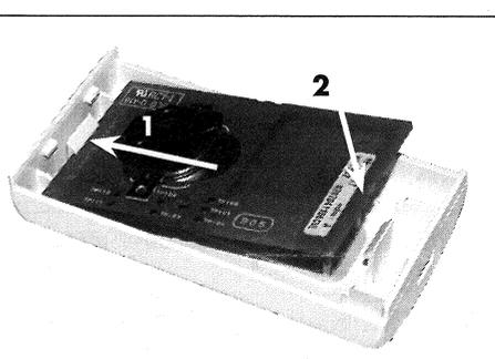
Insérez la carte électronique dans le boîtier amovible en respectant le sens de montage et en veillant à la positionner sous l'ergot.
