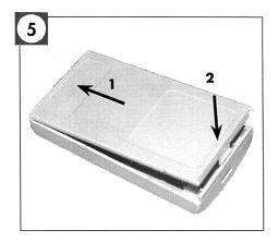
Insérez la face arrière dans les 2 ergots, puis fermez le boîtier.
