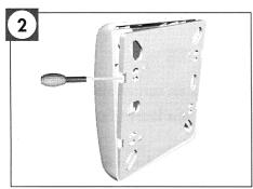
Ouvrez l'émetteur mural en déclipant les ergots de la face arrière.
