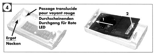
Insérez la carte électronique dans le boîtier amovible en respectant le sens de montage et en veillant à la positionner sous l'ergot.
