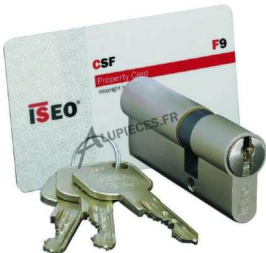
**DESCRIPTIF :** Cylindre 40x40 de sécurité avec carte de propriété avec 3 clés ISEO GERA F9 pour PY SOLEAL Finition nickelé. 6 goupilles inox para-centriques. Contre goupilles laiton diablo anti-crochetage. Goupille anti-perçage dans le stator. Panneton DIN en acier fritté incliné à 30°. Système anti-casse. Carte de propriété. Clé interdite à la reproduction à vie.
