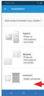
Choisir **BUBENDORFF** Module de connexion pour volets, puis suivre les différentes étapes indiquées pour que l'application Home + Control se connecte au module iDiamant.
