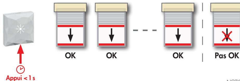
Si un volet ne se ferme pas, l'appairage de ce volet dans iDiamant n'a pas réussi. Recommencer l'appairage de ce volet à l'étape 1, séquence 2.
